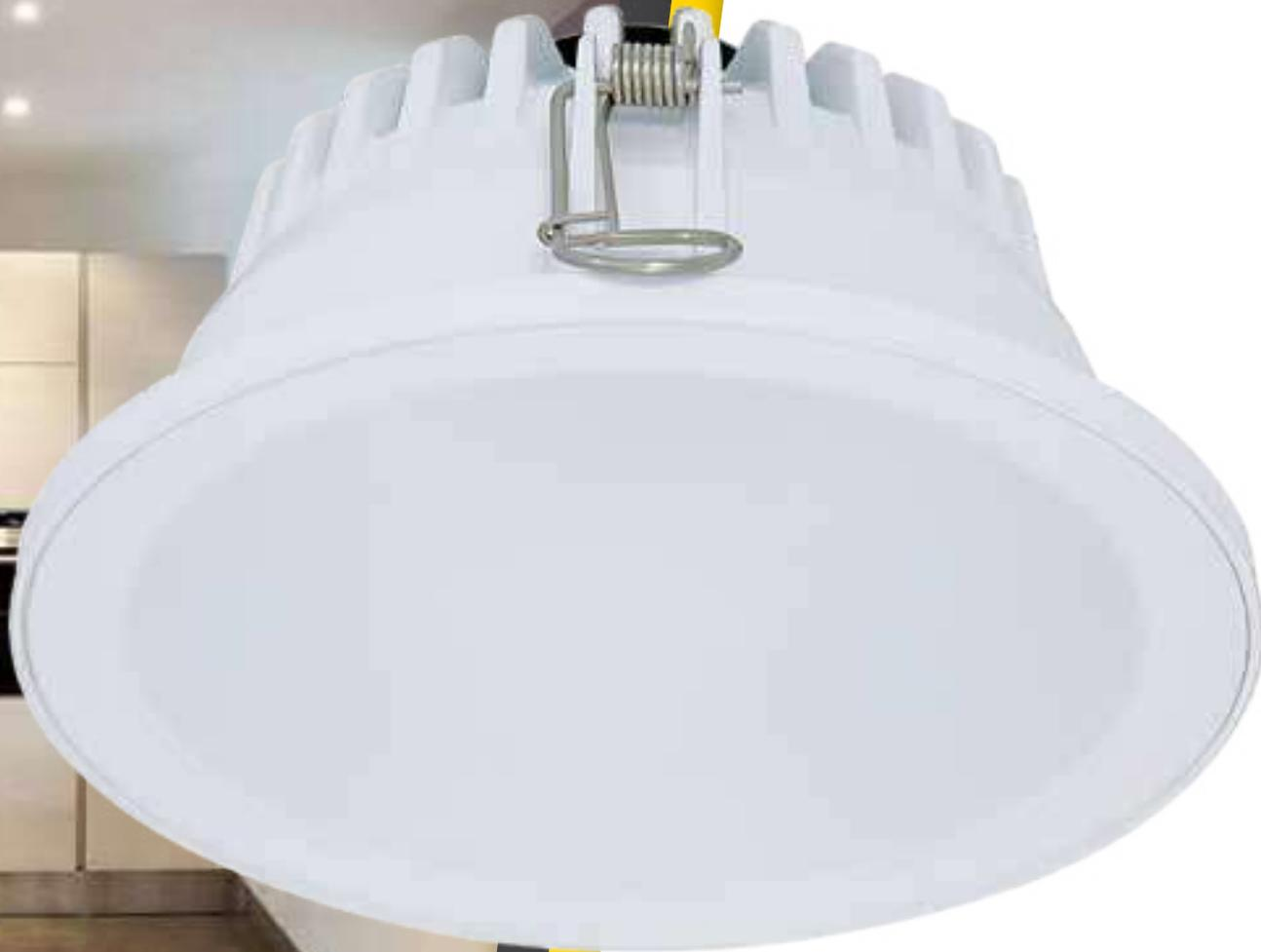
Luminario Downled de empotrar en bote integral o plafón. Cuerpo en inyección de aluminio, acabado con pintura electrostática de alta reflectancia en color blanco, refractor de acrílico de alta transmitancia, esmerilado y sellado totalmente, con tecnología LED.
